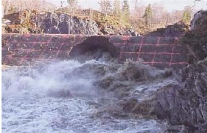
**Figure1. Rupture par érosion interne d'un barrage expérimental en terre (Höeg et al, 2004).**
